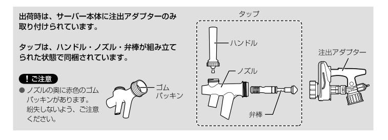
1 注出アダプターのタップ固定ナットと タップのネジ部を合わせる
